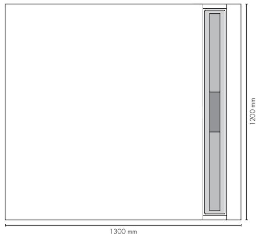
Modulo M-1 /Altura del cierre hidráulico 30 mm
